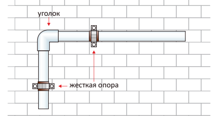
Крепление при разведении углом
