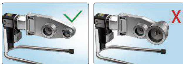
Правильное крепление нагревательных насадок
