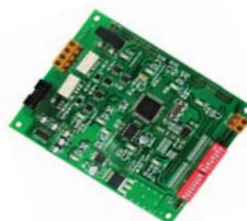
ML-1206.MX Модуль MODBUS Обеспечивает связь между системой управления зданием и системой пожарной сигнализации используя протокол связи MODBUS.
