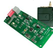
ML-1206.G Модуль GPRS Обеспечивает связь между программой Supervisor и системой пожарной сигнализации с помощью оператора GSM используя протокол связи GPRS.
