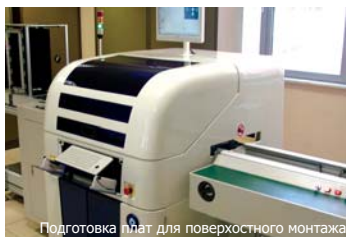
Подготовка плат для поверхностного монтажа
