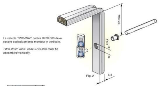
Клапан Two – Way арт. 0736080 должен быть установлен обязательно в вертикальном положении.
