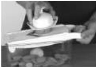
1. Положите нарезаемый продукт (или, если продукт уже нарезан, положите его ровной поверхностью вниз) на терочную поверхность (1). Установите зажим посередине, чтобы удерживающие шипы пресса (10), т. е. 3 встроенных металлических шипа (11) вошли в нарезаемый продукт (см. рис. 3). Это предотвращает случайное соскальзывание продукта во время нарезания.
