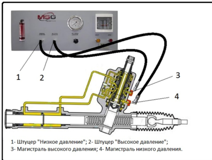
Рис. 4. Подключение рулевой рейки к стенду
