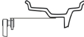
Рисунок 6.14 – Прямой ввод диаметра при статической балансировке при помощи выноски
