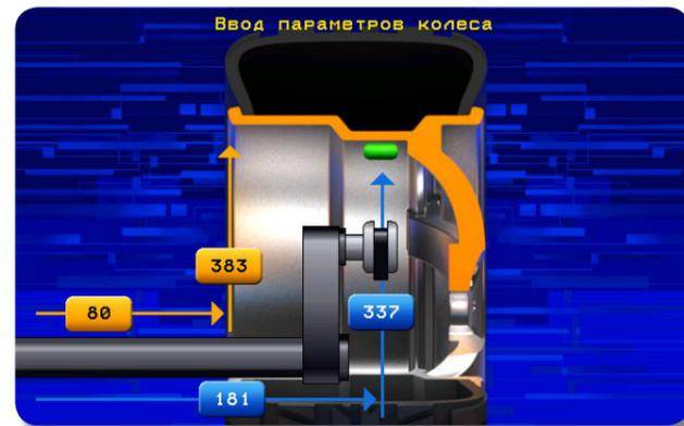
Прямое измерение осуществляется автоматически двумя электронными линейками. Для ввода размера достаточно подвести линейку к плоскости установки груза.
