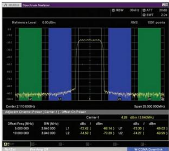
W-CDMA ACLR, 1 несущая (TestModel1, 64DPCH)
