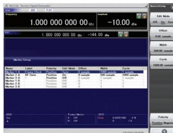
Экран настройки маркера SG2 Memory A (1A/2A/3A), Memory B (1B/2B/3B)
