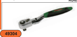
Трещоточная рукоятка мини 1/4"DR, с гибкой головкой, 60 зубцов
