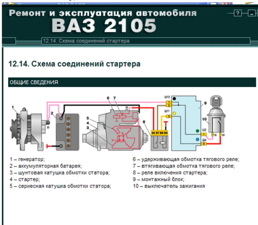
**Выводы:** двух-обмоточное втягивающее реле меньше нагревается при длительном включении и дает меньший всплеск напряжения самоиндукции, при отключении питания.
