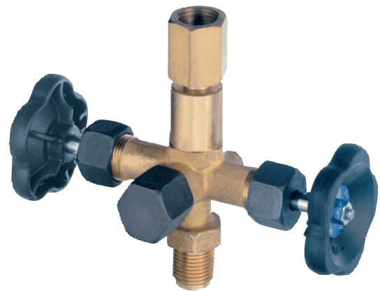
Запорный клапан с отдельно изолируемой точкой подключения контрольного манометра по стандарту DIN 16272, накидная гайка с левой/правой резьбой G 1/2, с диагностическим соединением M20 x 1,5, PN 400
