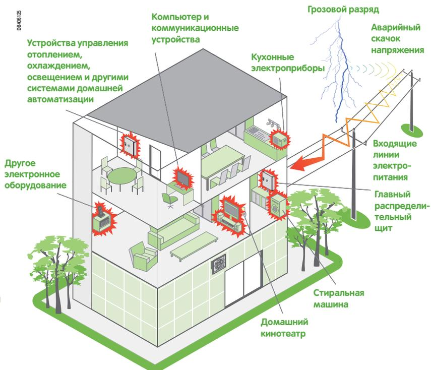
Грозой разряд вблизи от дома или рядом с воздушной линией электропитания вызывает резкое повышение бытового напряжения питающей сети до нескольких киловольт. В сравнении, бытовое напряжение составляет 230 В.
