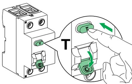
Тестирование УЗО один раз в месяц позволяет подтвердить его работоспособность. Исправное УЗО выключится и отключит напряжение.
