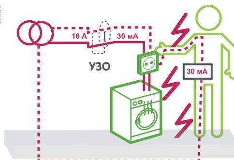
Измеряя разность силы тока между проводником под напряжением и нулевым проводником, дифференциальный выключатель нагрузки фактически обнаруживает ток, протекающий не по предусмотренной схеме нейтрали, в том числе через тело человека. Если этот ток достигает указанного на УЗО порога, дифференциальный выключатель нагрузки отключается в течение нескольких миллисекунд, предупреждая таким образом телесные повреждения или более тяжёлые последствия.
