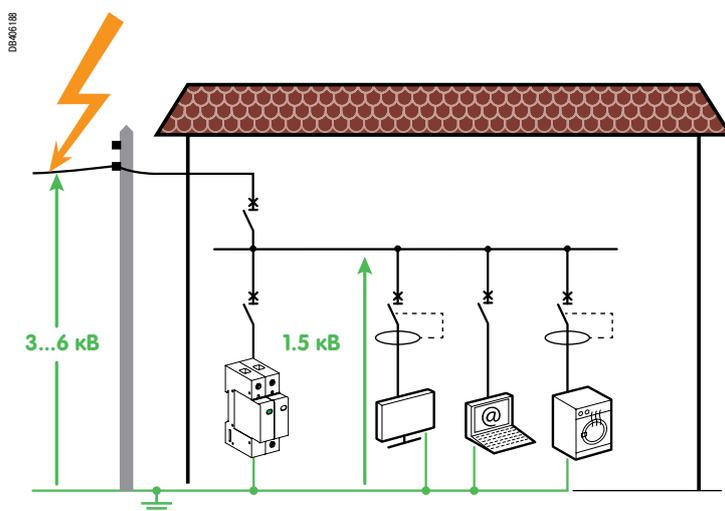
УЗИП ослабляет скачок напряжения до значения, выдерживаемого подключёнными приборами (до 1,3 или 1,5 кВ, см. значения уровня защиты от перенапряжений (Up)).
