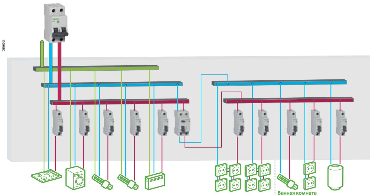
В соответствии с нормативными требованиями один дифференциальный выключатель нагрузки (УЗО) может обеспечивать защиту всех розеток и всего электрооборудования в ванной комнате.
