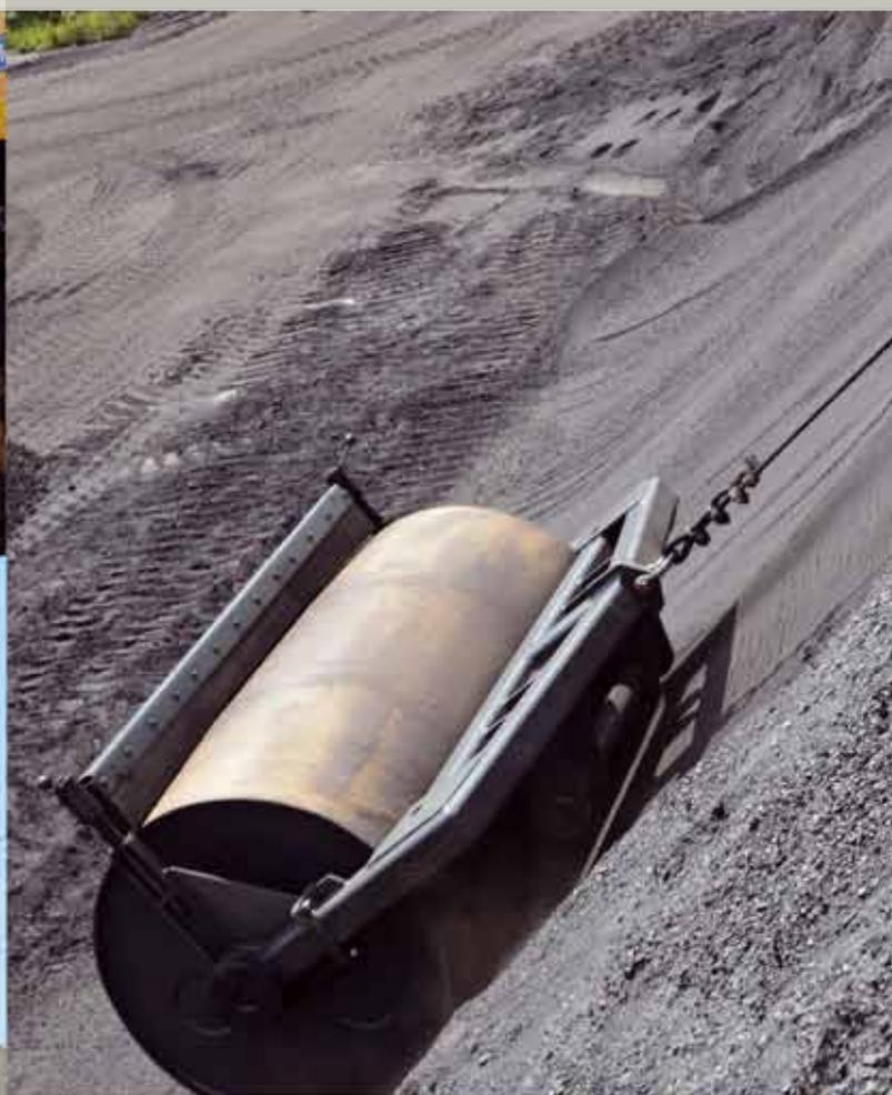
Управление уплотнительным катком осуществляется из кабины оператора с помощью джойстика. Функциональность и удобство расположения кресла оператора обеспечивают отличную видимость катка и всего рабочего пространства на склоне угольного отвала. Оператор имеет возможность сидеть лицом к уплотняемому склону.
