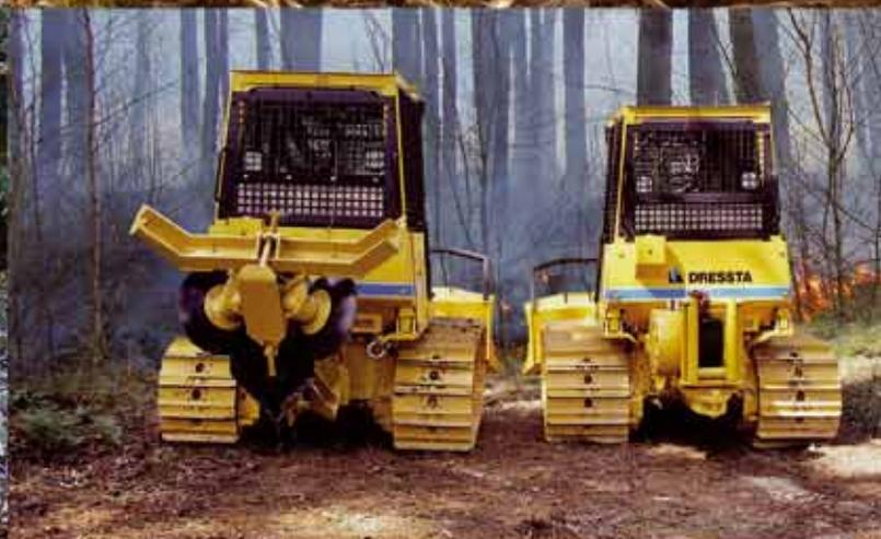
Передняя и задняя дуги безопасности могут использоваться как для бульдозера без кабины – машина с навесом и защитой от опрокидывания (ROPS), так и для бульдозера с кабиной и защитой ROPS (в комплекте с защитными сетками стёкол кабины) в качестве дополнительного оборудования для всех моделей бульдозеров, начиная от TD-25M/R и заканчивая TD-14M/R.
