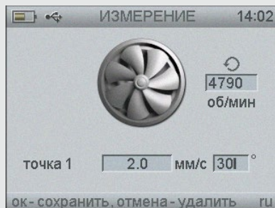
Измерение амплитуды вибрации и фазы
