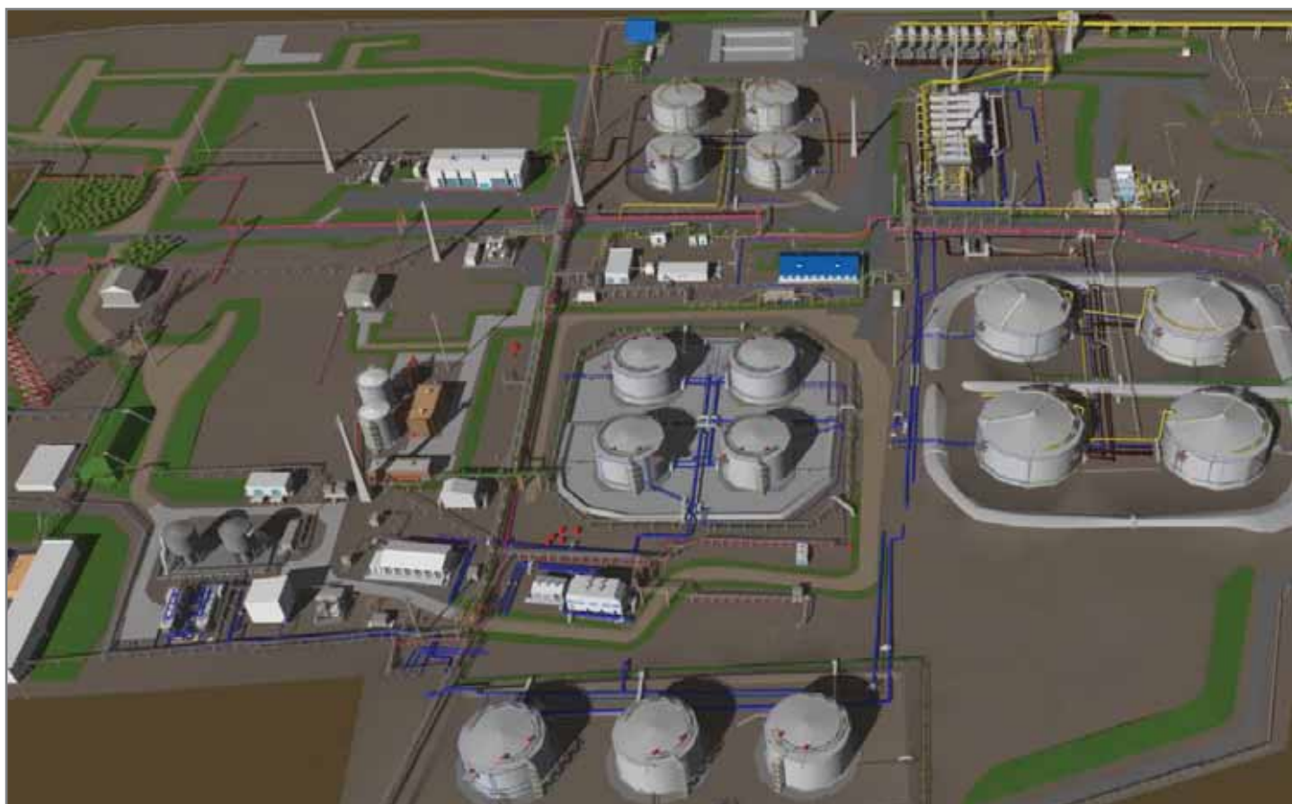
Трехмерная информационная модель КСП9 Самотлорского месторождения, созданная в Model Studio CS
