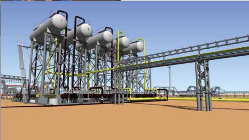
Фрагменты комплексной информационной модели КСП9 Самотлорского месторождения, созданной в Model Studio CS
