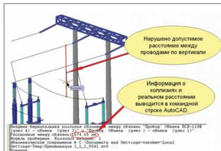
Коллизия, обнаруженная при проверке допустимых расстояний в Model Studio CS OPУ
