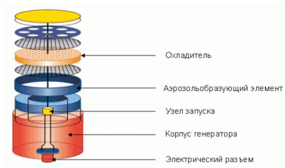
При возникновении пожара или угрозе взрыва защищаемого объекта узел запуска ГОА автоматически (через термошнур при повышении температуры окружающей среды до  $170^{\circ}\text{C}$ ) или по команде с пульта управления инициирует воспламенение аэрозольобразующего элемента.
