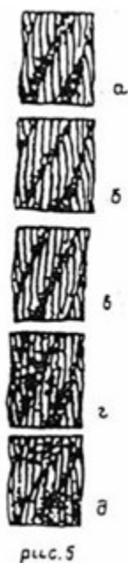
Рис. 5. Поверхностная коррозия проволок каната крестовой свивки: a - начальное окисление поверхности; б - общее окисление поверхности; в - заметное окисление; г - сильное окисление; д - интенсивная коррозия
