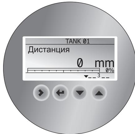
Дисплей может быть заказан вместе с устройством, либо отдельно, как аксессуар. Он отображает данные измерений на 128 × 64 пиксельном экране. С помощью меню настройки на дисплее можно быстро настроить прибор за несколько интуитивно понятных шагов. Доступны 9 языков.
