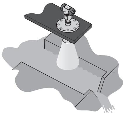
Полевые устройства могут измерять расход, если они используют программное обеспечение PACTware™. Функция преобразования расхода поддерживается драйвером DTM, поставляемым вместе с прибором. В меню доступны для выбора 6 профилей потока: Parshall (ISO 9826), Venturi Rectangular (ISO 4359), Venturi Trapezoidal (ISO 4359), Venturi U (ISO 4359), V-Notch (ISO 1438) или Rectangular Notch (ISO 1438).
