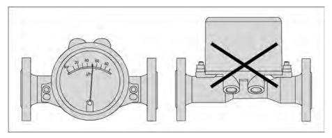
Для соответствия температурным параметрам и точности измерения расходомеры Н250Н для монтажа в горизонтальном положении должны монтироваться в трубопровод таким образом, чтобы дисплей располагался сбоку измерительной трубы. Указанные максимальные температуры измеряемой и окружающей среды, а также погрешность измерения основаны на боковом монтажном положении индикатора.
