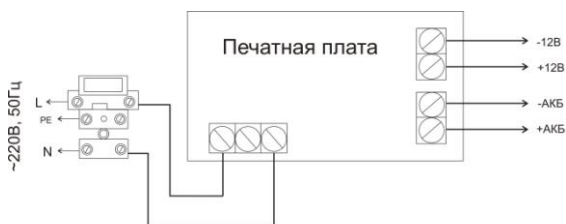
Рис. 1. Схема подключения Optimus 1220-RM-7
