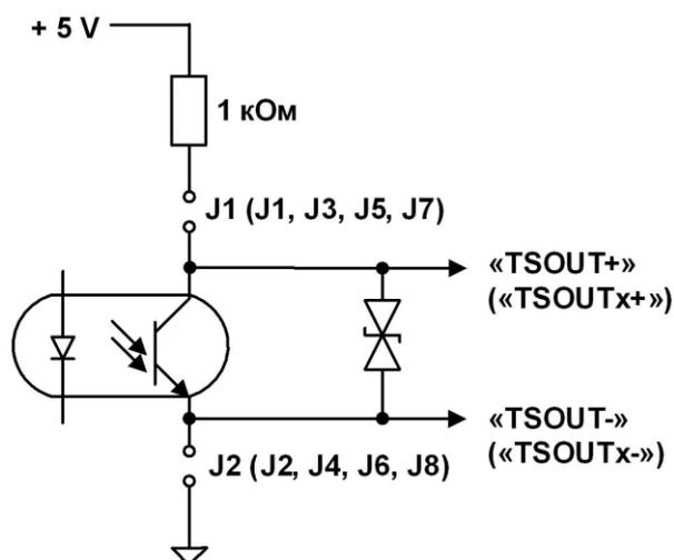
Рис.Ж.1. Схема оконечного каскада универсальных выходов.
