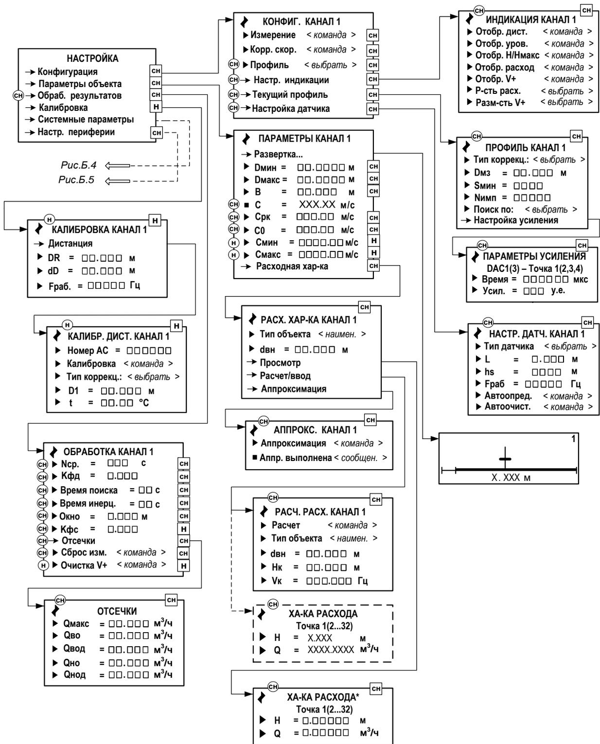
\* - при выборе типа объекта **труб.** или **U-обр.** открывается меню расчета расходной характеристики **РАСЧ. РАСХ. КАНАЛ X**, при выборе **произв.** – меню ввода расходной характеристики **ХАР-КА РАСХОДА Точка 1(2...32)**
