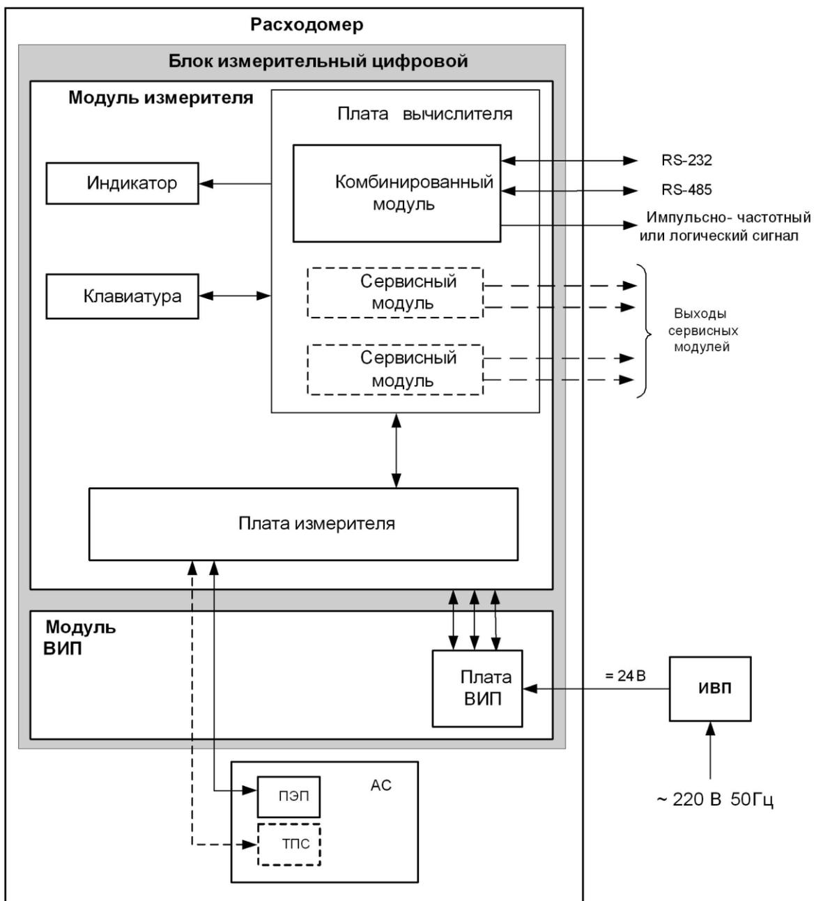
*АС – акустическая система; ВИП – встроенный источник питания; ИВП – источник вторичного питания; ПЭП – пьезоэлектрический преобразователь; ТПС – термопреобразователь сопротивления.*
