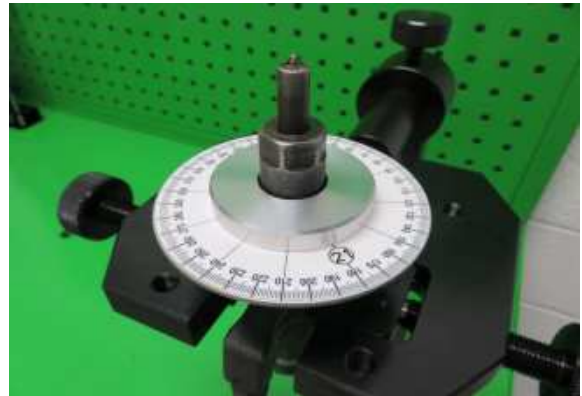
DL-CRN50108 Угломер для форсунок с диаметром гайки распылителя 21мм Диапазон углов: 0° - 360°.
