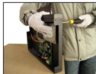
3.закрутите винты жесткого
