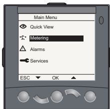
Дисплей щитового индикатора FDM121: перемещение по меню
