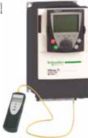
Конфигурирование ПЧ Altivar 71 с помощью мультизагрузчика
