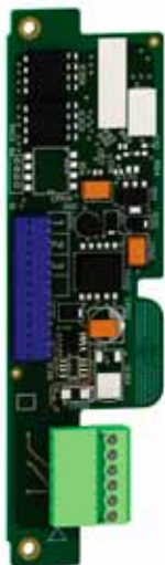
Интерфейсная карта датчика VW3 A3 401
