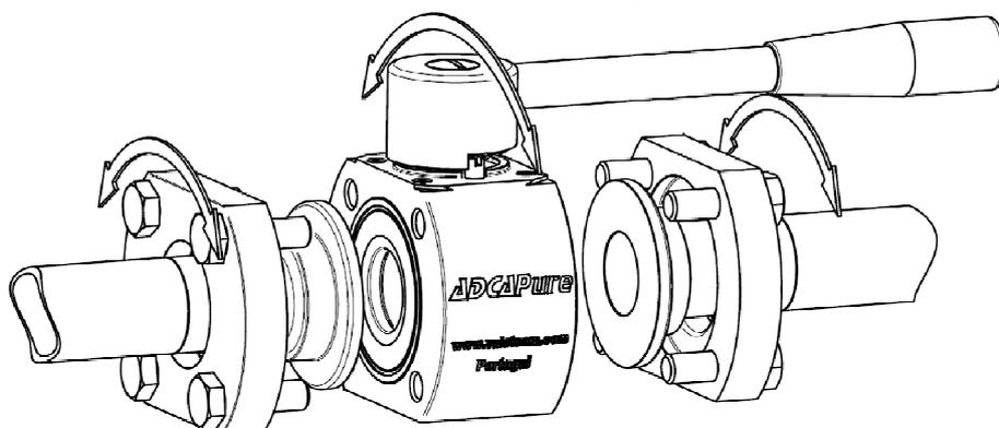
Накидные фланцы позволяют осуществлять приварку патрубков произвольно. После установки шаровый кран может вращаться на 360° вокруг оси трубы для выбора наиболее оптимального положения.
