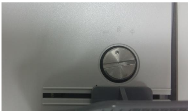
Рисунок 3. Винт регулировки ширины приемной щели счетчика
