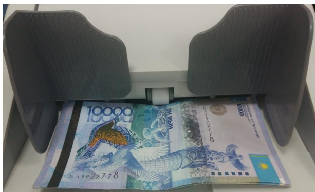
Рисунок 1. Банкноты помещены в загрузочный карман между направляющими
