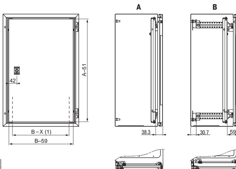
(1) Размер при установке на ступенчатых направляющих: B-83 мм.
