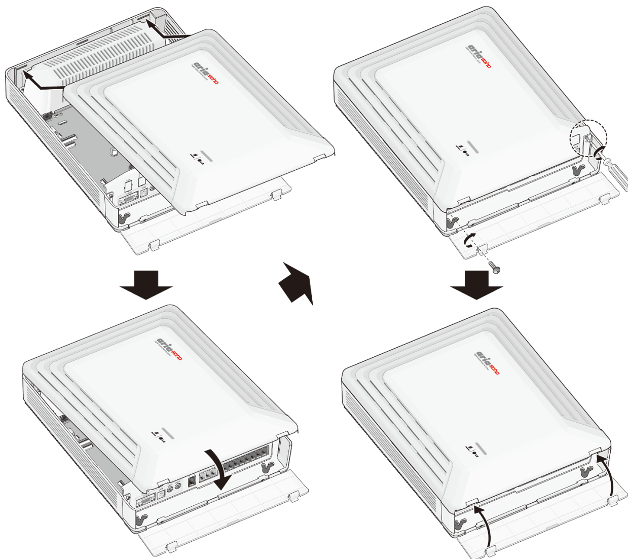
Рис. 3.2.3.2 Установка лицевой панели
