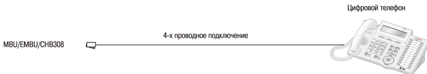
Рис. 5.1.2.1 Подключение цифрового аппарата и консоли DSS
