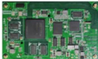
**D0152 4x DVB-S/S2 Demodulator Module**
