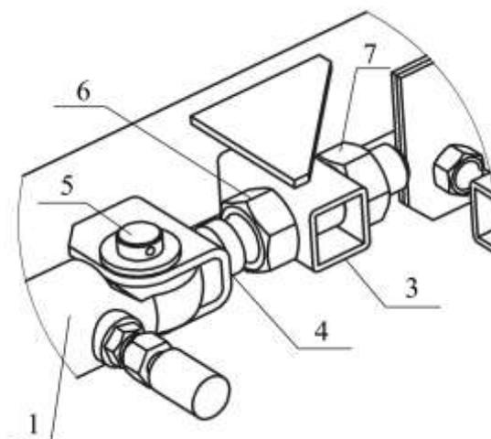
Рис. 15. Элементы регулировки гидроцилиндра складывания штанги.
