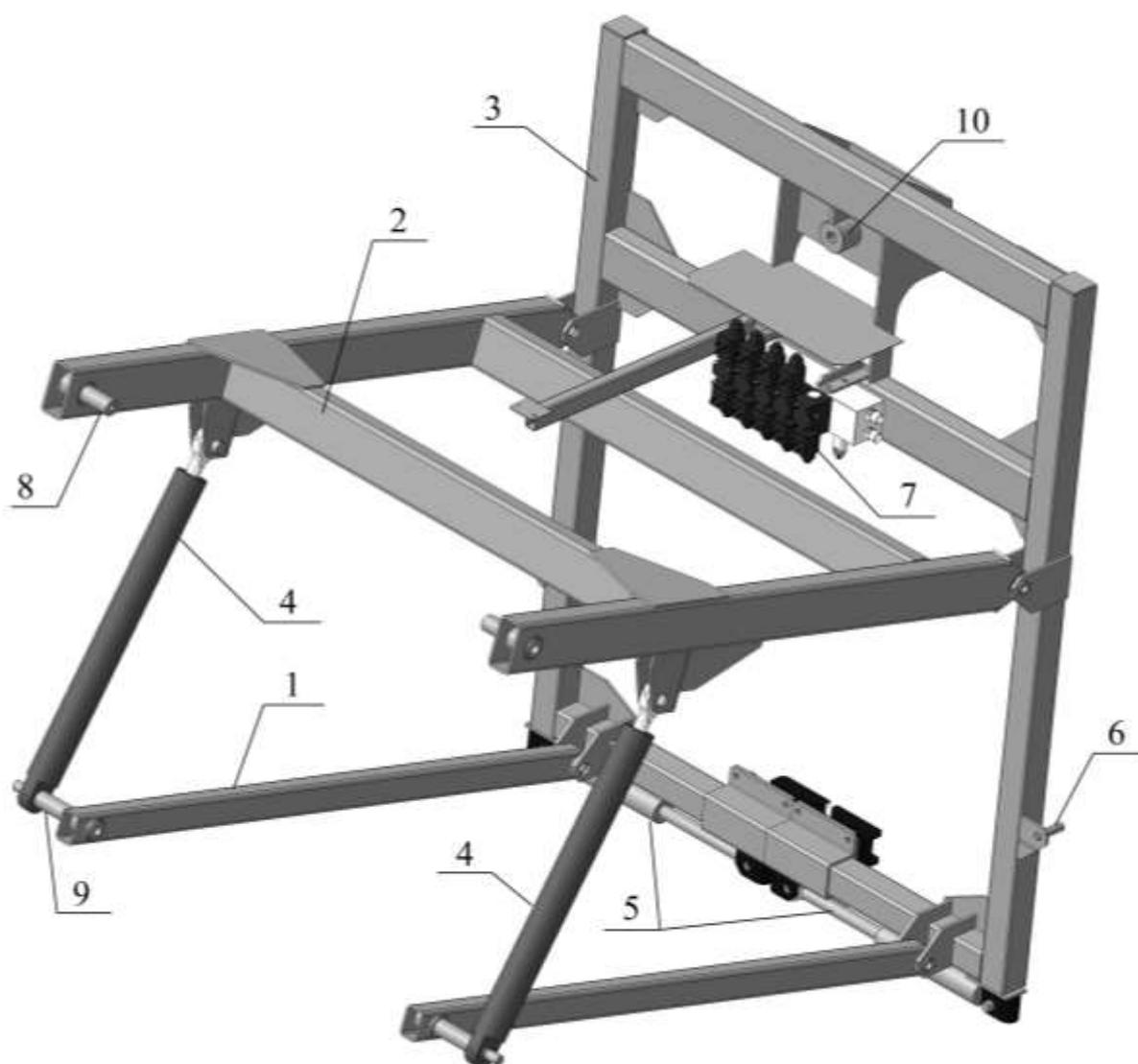
Рис. 8. Механизм подъема штанги.
