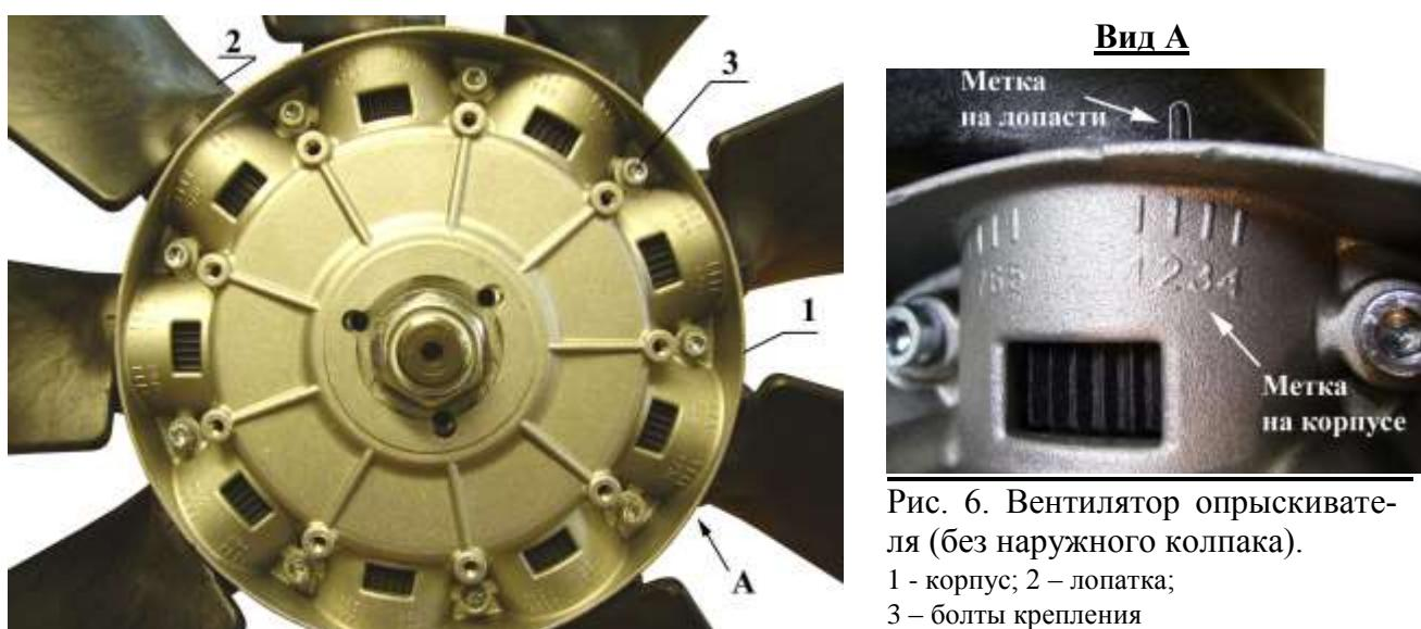
Рис. 6. Вентилятор опрыскивателя (без наружного колпака).
