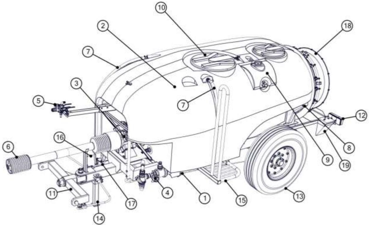
Рис. 1. Опрыскиватель ОВС-2000.
