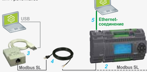
Удалённое программирование - M172 performance
