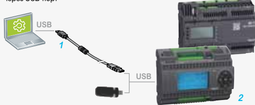
Локальное программирование, загрузка - M171 & M172 performance - через USB-порт
