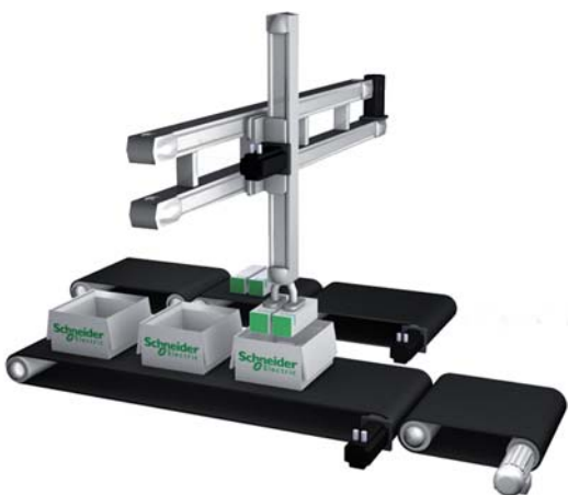
Сервопривод LXM 32: управление упаковочным станком
