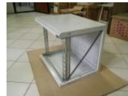
**К ВЕРХНЕЙ И НИЖНЕЙ ЧАСТИ ШКАФА ПО ДИАГОНАЛИ КРЕПИМ УСИЛЕНИЕ.** При сборке используется винт-саморез 3.9 x 9.5, винт M4 x 12 и гайка M4.
