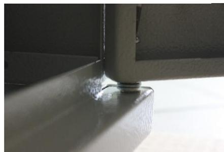
**ПРОИЗВОДИМ МОНТАЖ ДВЕРИ.** Используется Винт M5\*20 полуцилиндр. Для выравнивания двери подкладывается шайба Ø 5. Для удобства регулировки нижний винт двери перед установкой немного вывинчивается.
