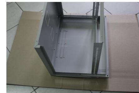
**К НИЖНЕЙ ЧАСТИ ШКАФА КРЕПИМ ЗАДНЮЮ СТЕНКУ И РАМУ 19".** При сборке используется винт-саморез 3.9 x 9.5 полуцилиндр.
