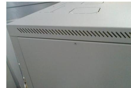
**ДЛЯ СЕРИИ BASIS: УСТАНОВЛИВАЕМ БОКОВЫЕ СТЕНКИ ШКАФА.** При сборке используется винт M4\*25 потай.
