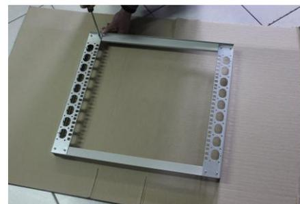
**ПРОИЗВОДИМ СБОРКУ РАМЫ 19" ИЗ ОЦИНКОВАННЫХ НАПРАВЛЯЮЩИХ И УГОЛКОВ.** При сборке используется винт-саморез 3.9 x 9.5 полуцилиндр.
