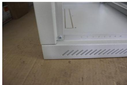
**ФИКСИРУЕМ ЗАДНЮЮ СТЕНКУ ШКАФА ПО БОКАМ ВНИЗУ.** Операция повторяется при креплении верхней части шкафа. При сборке используется винт-саморез 3.9 x 9.5 полуцилиндр.
