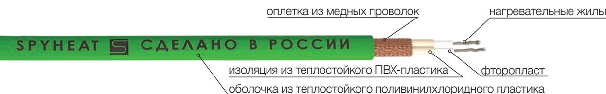
В комплектах SHD-15 использован кабель с удельным тепловыделением 15 Вт/пог.м (CD-15). Кабель имеет овальное сечение 7×4 мм. Эти наборы применяют для создания теплых полов. При использовании такого кабеля достигается оптимальная равномерность нагрева пола, исключая эффект тепловой «зёбры», и высокая скорость достижения заданной температуры.
