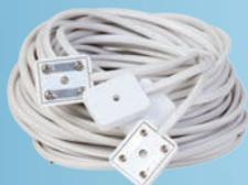
Датчик воды предназначен для фиксации аварийной ситуации при попадании воды на контактные пластины датчика, что вызывает падение сопротивления между ними.
