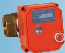
Кран шаровой с электроприводом предназначен для блокировки водоснабжения в случае протечки. Кран устанавливается в водоразборном шкафу сразу после вводных вентилей. Напряжение питания электропривода 5 вольт (безопасно для использования в быту).
