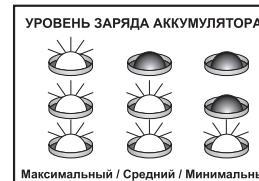
На Вашем изделии установлены индикаторы, которые позволяют контролировать степень заряда аккумуляторной батареи. Для реверса нажмите кнопку 10. Индикаторы 6 показуют состояние батареи.
