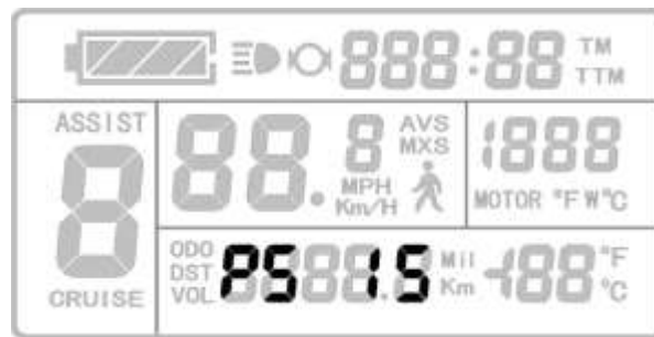
Демонстрация установки параметра P5
