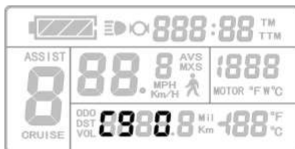
Демонстрация установки параметра С9
