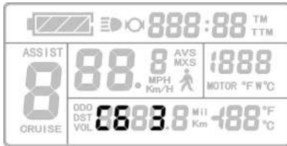
Демонстрация установки параметра C6
