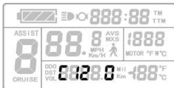
Демонстрация установки параметра C12
