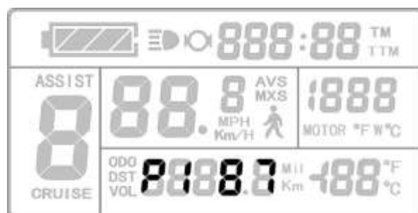
Демонстрация установки параметра P1
