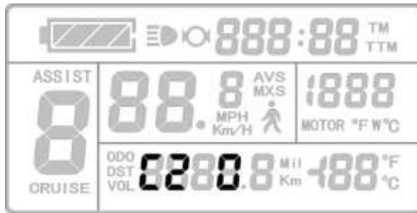
Демонстрация установки параметра C2
