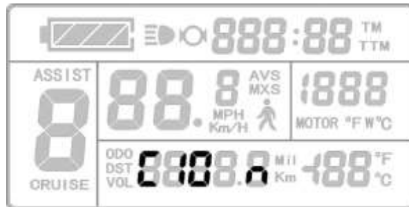
Демонстрация установки параметра С10
