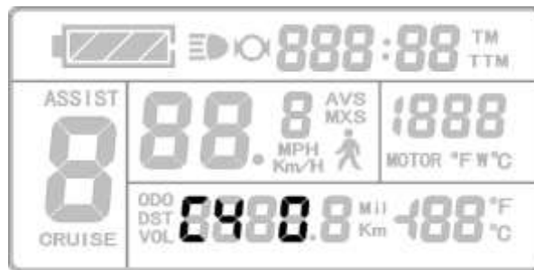
Демонстрация установки параметра С4
