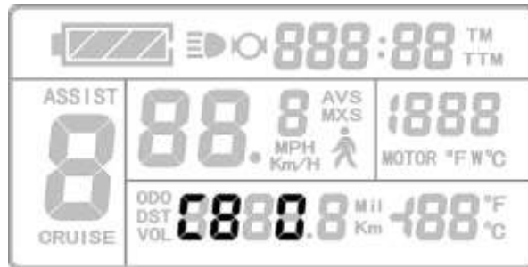
Демонстрация установки параметра С8
