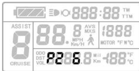
Демонстрация установки параметра P2
