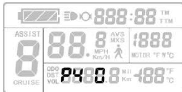
Демонстрация установки параметра P4
