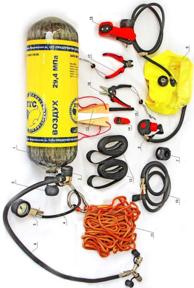
1 – баллон; 2 – вентиль; 3 – редуктор; 4 – шланг высокого давления; 5 – сигнальное устройство; 6 – воздухопроводный шланг; 7 – переходник; 8 – легочный автомат со шлангом; 9 – спасательное устройство; 10 – шланг-удлинитель и изделия комплекта инструмента и принадлежностей; (11 – страховочный канат; 12 – эвакуационные петли; 13 – клинья; 14 – нож – стропорез; 15 – маркер; 16 – усиленные ножницы; 17 – бокорезы; 18 – фонарь
